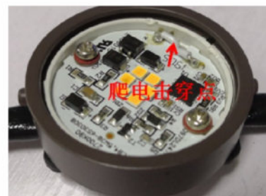
耐压试验期间出现爬电击穿
