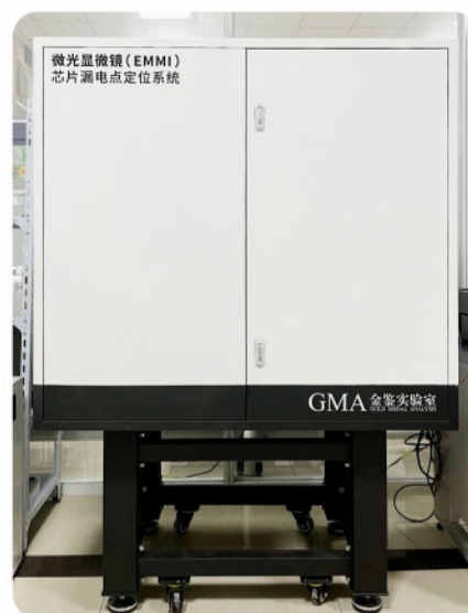
微光显微镜 (EMMI) 芯片漏电点定位系统
