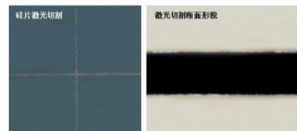
电镜激光制样，可硅片切割
